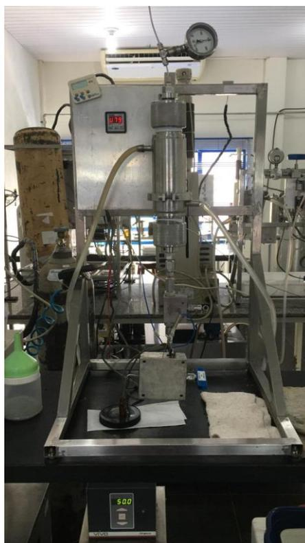
Figura 6. Extrator supercrítico. Fonte: Arquivo pessoal.
